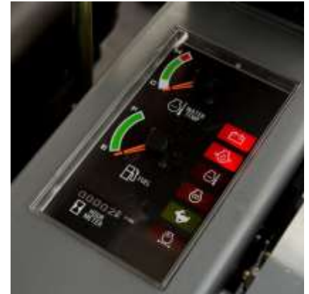
Quadro strumenti con spie di allarme e di servizio.
