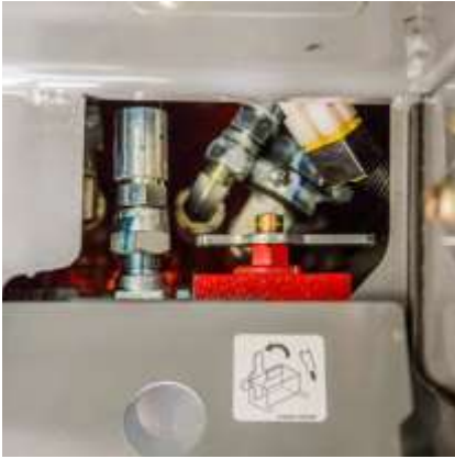
Valvola selettore flusso ausiliario per impostare singolo effetto o doppio effetto. Sotto il tappeto.
