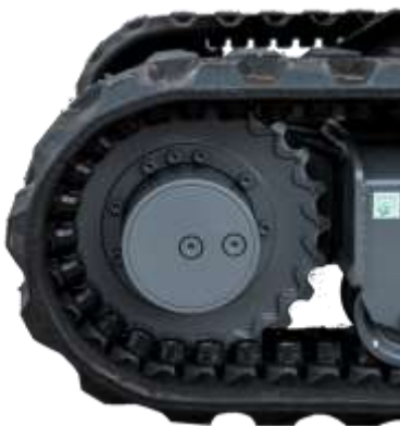
Motore di traslazione con inserimento automatico della marcia ridotta quando è richiesta forza per spingere o spianare.
