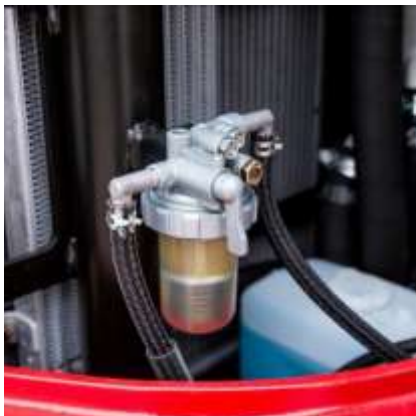
Filtro gasolio e separatore acqua
