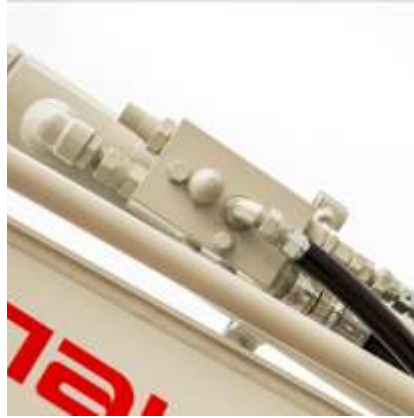
Valvole di sicurezza per versione Advanced su braccio scavo e avambraccio, con allarme.
